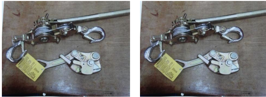
43. รอกดึงสายไฟขนาด 1 ตัน พร้อมปากกาจับสายไฟขนาด 2.5 มิลลิเมตร
